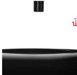
กระจกแบบซูเปอร์ไฮโดรฟิลิก (น้ำไม่เกาะเป็นหยด) หลังเคลือบด้วยน้ำยา
